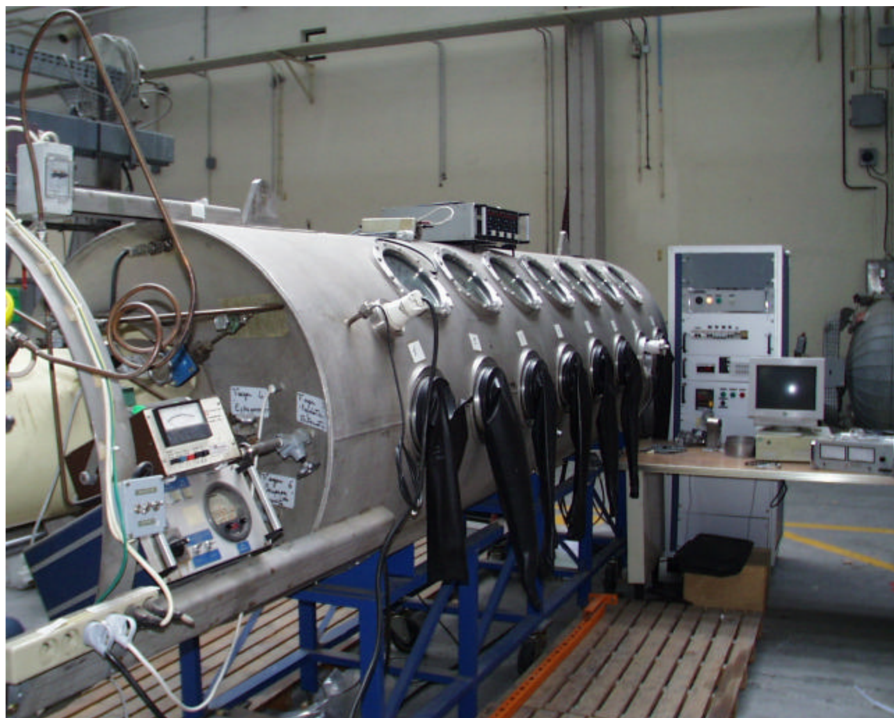
figure 19 : Photo de la boîte à gants Pénélope
